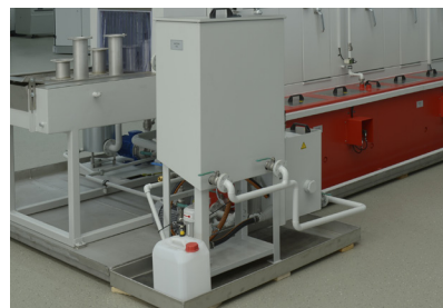
Séparateur d'huile UNI - pour les huiles et graisses en surface
