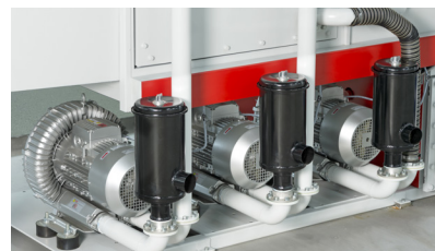
Compresseur à canal latéral (option) pour des résultats de séchage optimisés
